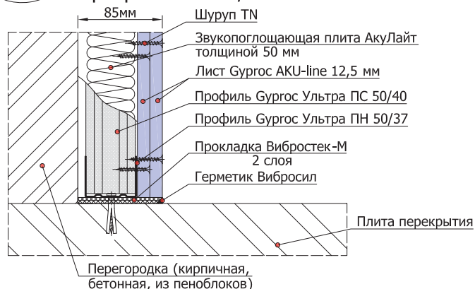
2.02.2 Примыкание облицовки стен к дверному проёму. Оформление внутреннего угла
