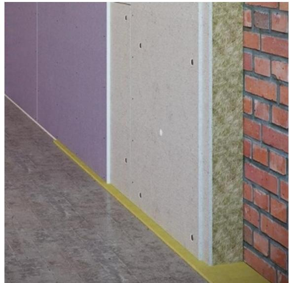
**Площадь: 13 м<sup>2</sup>****Толщина конструкции: 133 мм****ΔRw \* ~ 16-18 дБ**
