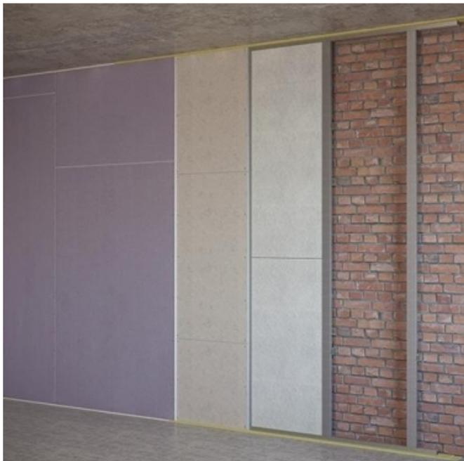
Конструкция звукоизоляционной каркасной облицовки состоит из слоя звукопоглощающих плит Шуманет-ЭКО, акустического триплекса Саундлайн-dB, финишных листов NIDA CICHА, виброизоляционной ленты Вибростек-М 100, герметика Ultrakustik VS, металлических профилей CD60 и UD27, виброподвесов VibroElastic.
