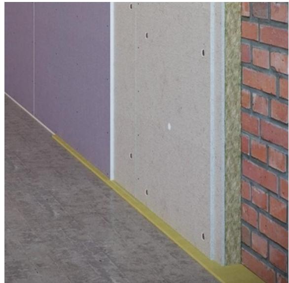
**Площадь: 1 м<sup>2</sup>****Толщина конструкции: 83 мм****ΔRw \* ~ 12 – 14 дБ**
