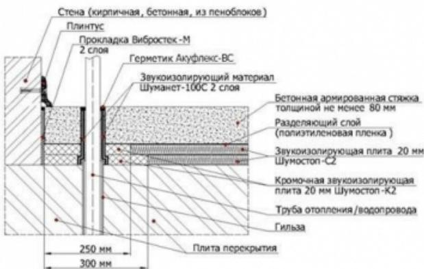
При устройстве конструкции звукоизоляционного пола применяются следующие материалы:
